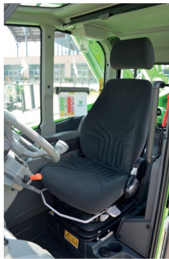
ROPS, FOPS LEVEL II Rispetto al modello precedente è forse la cabina a non cambiare. Integralmente realizzata da Merlo, in questa versione è certificata per resistere ad un ribaltamento di una macchina di massimo 23.500 kg. Il 60.27S Plus pesa 17.900 kg.
