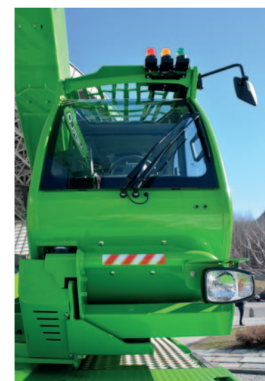
ROPS, FOPS LEVEL II Rispetto al modello precedente è forse la cabina a non cambiare. Integralmente realizzata da Merlo, in questa versione è certificata per resistere ad un ribaltamento di una macchina di massimo 23.500 kg. Il 60.27S Plus pesa 17.900 kg.
