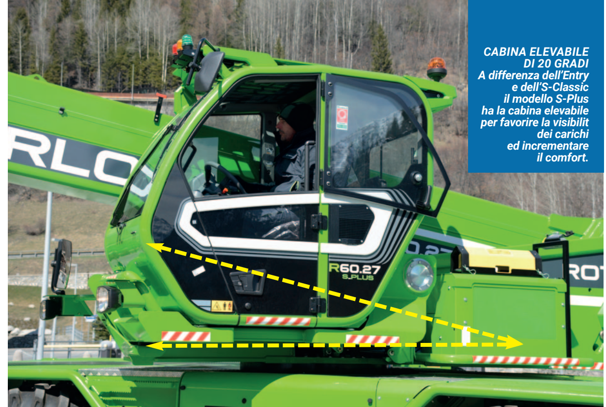
ROPS, FOPS LEVEL II Rispetto al modello precedente è forse la cabina a non cambiare. Integralmente realizzata da Merlo, in questa versione è certificata per resistere ad un ribaltamento di una macchina di massimo 23.500 kg. Il 60.27S Plus pesa 17.900 kg.
