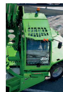
ROPS, FOPS LEVEL II Rispetto al modello precedente è forse la cabina a non cambiare. Integralmente realizzata da Merlo, in questa versione è certificata per resistere ad un ribaltamento di una macchina di massimo 23.500 kg. Il 60.27S Plus pesa 17.900 kg.
