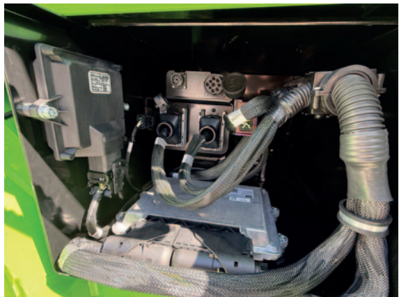
AUTOMAZIONI UTILI Il nuovo distributore con spole elettroniche ad azionamento millimetrico controllato elettronicamente permette di implementare nuove funzioni.
