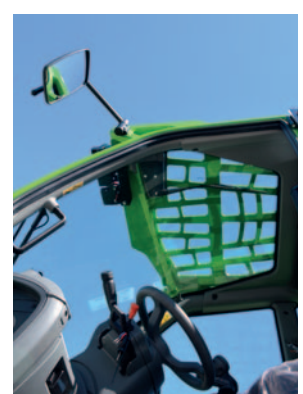
ROPS, FOPS LEVEL II Rispetto al modello precedente è forse la cabina a non cambiare. Integralmente realizzata da Merlo, in questa versione è certificata per resistere ad un ribaltamento di una macchina di massimo 23.500 kg. Il 60.27S Plus pesa 17.900 kg.
