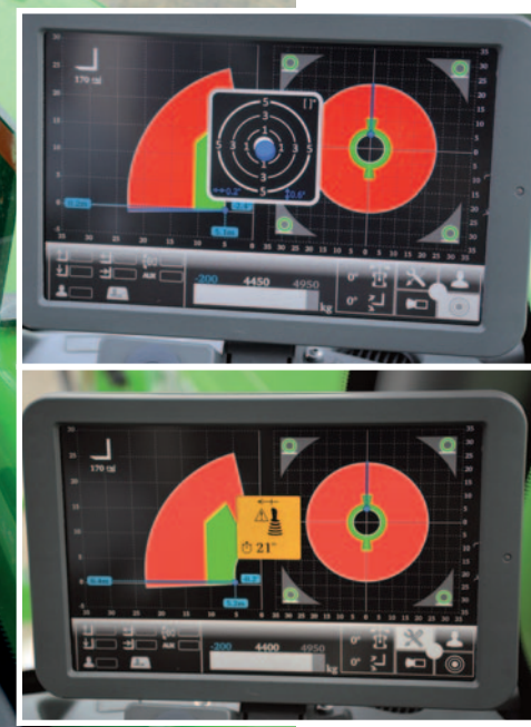
BOLLA E BOOST Sopra la bolla elettronica per stabilizzare la macchina e (icona gialla) il boost di potenza da massimo 30 secondi.
